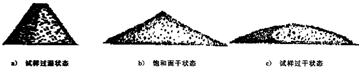
图4 天然砂饱和面干状态示意图
